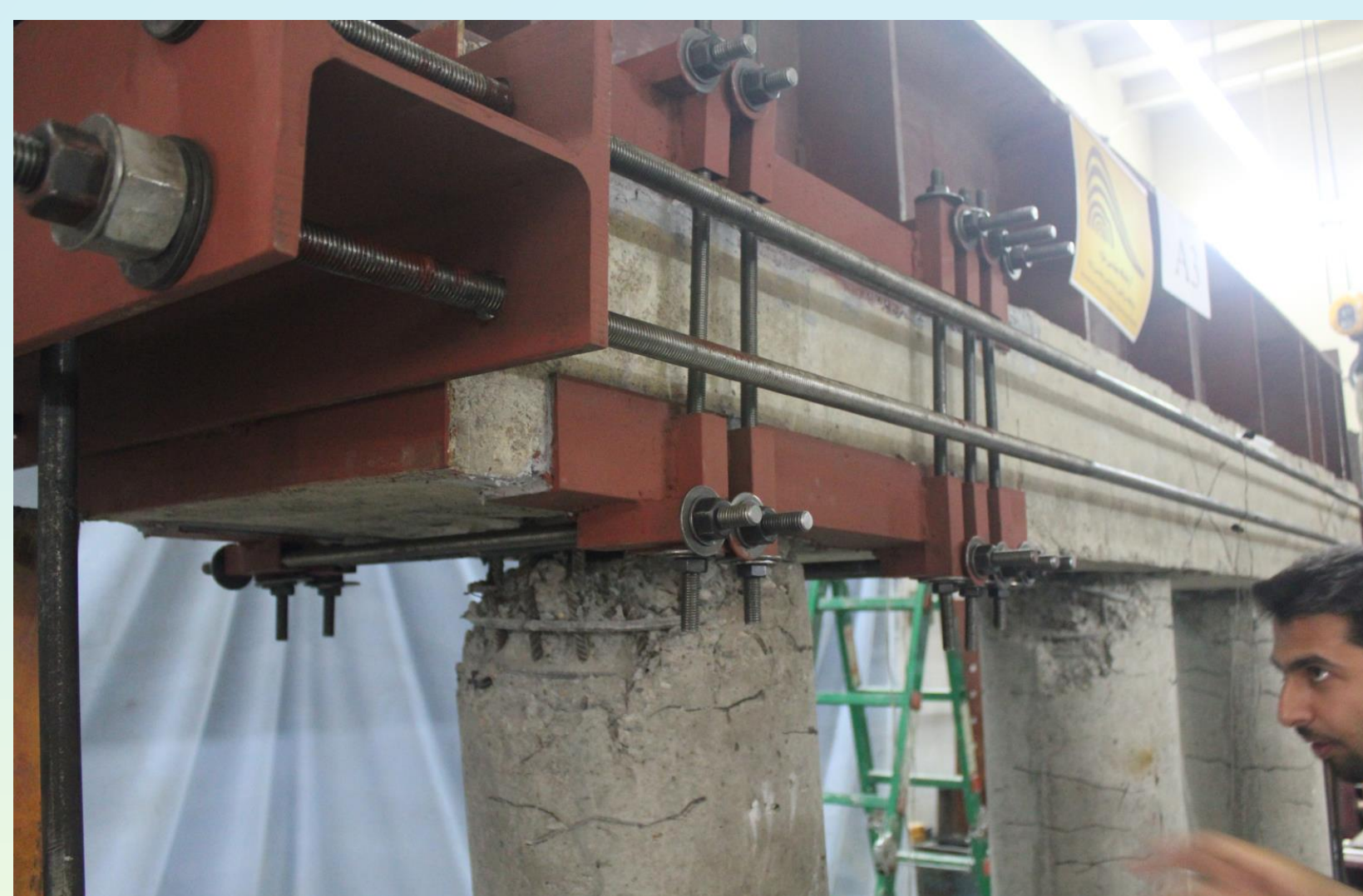
ژاکت فلزی در محدوده اتصال و تنیدگی طولی تیر سرستون
